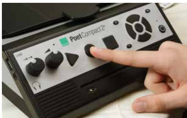
Vorlesen auf Knopfdruck: als 2 Tasten- oder 3 Tasten-Version mit Menü-Tastenfeld.
