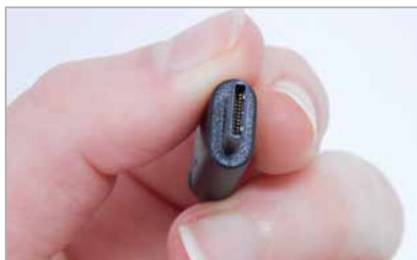
Le connecteur USB de type C peut être facilement branché dans les deux sens.
